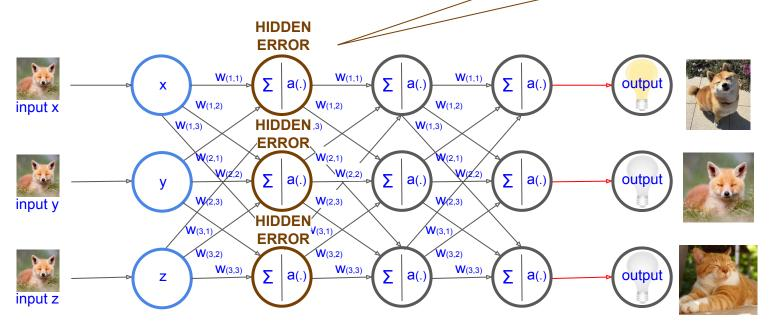
$E_{\text{(hidden)}} = W_{\text{(hidden\_output)}} \cdot E_{\text{(output)}}$
