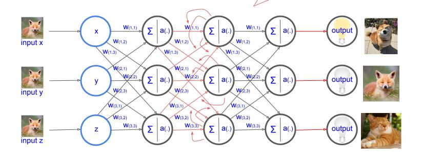
$E_{\text{(hidden)}} = W_{\text{(hidden\_output)}} \cdot E_{\text{(output)}}$
